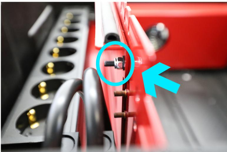
Hierzu muessen Sie die M4 Mutter auf der Innenseite mit einer Zange, Ratsche oder einem Gabelschluessel festhalten.
